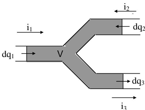
La conservation de la charge contenue dans le volume V se traduit par  $dq_1 + dq_2 = dq_3$  soit  $i_1 + i_2 = i_3$
